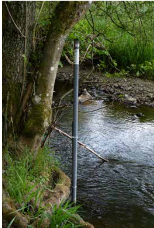
Dispositif de suivi du niveau et de la température de l'eau à l'aide d'enregistreurs automatiques
